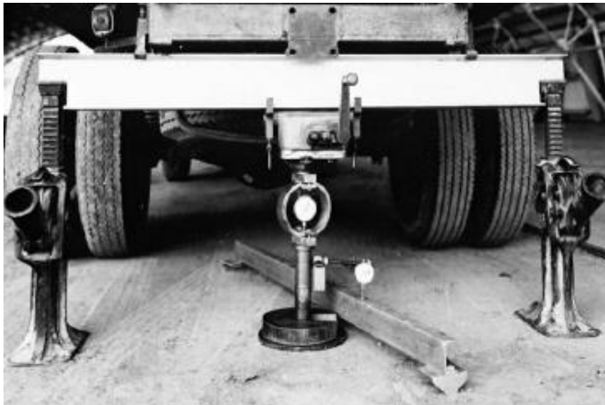
Figura 169 - 1. Montaje para el ensayo CBR in-situ
