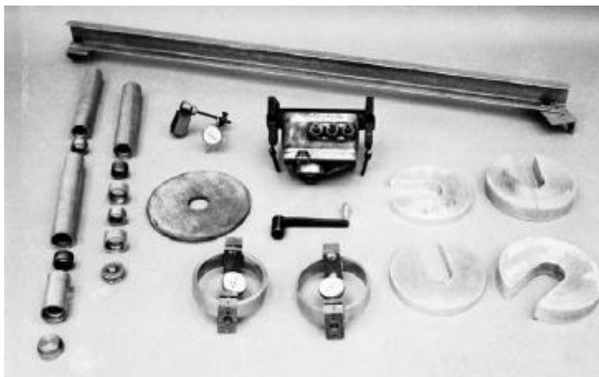
Figura 169 - 2. Elementos para el ensayo CBR in-situ
